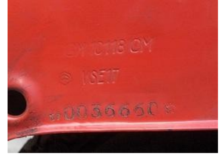
Numero di telaio punzonato (si consiglia eventuale funzione macro o super macro)
